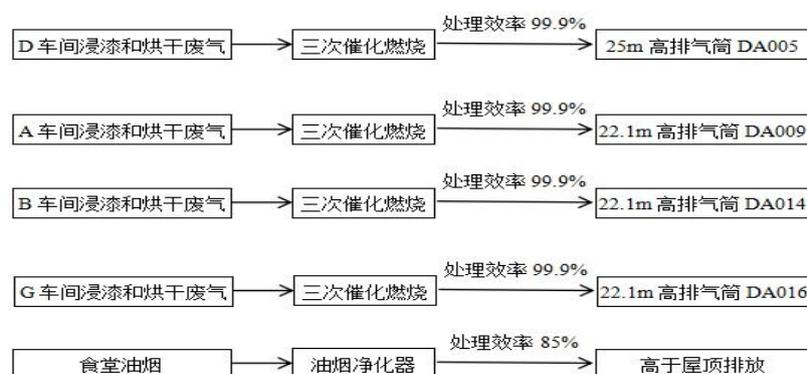
图 4.1.2-1 废气处理工艺流程图
